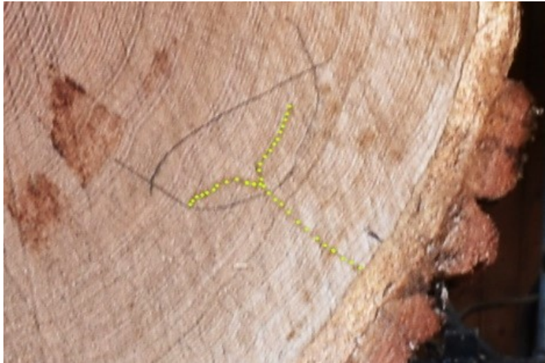
Abb. 11: Gelb markierte, über den Bohrgang hinausgehende Verfärbungen. Die Bohrgänge selbst befanden sich außerhalb des Schnittes. (Bleistiftumrahmung diente der Kennzeichnung im Sägewerk) (Quelle: NW-FVA, Abteilung Waldschutz)
