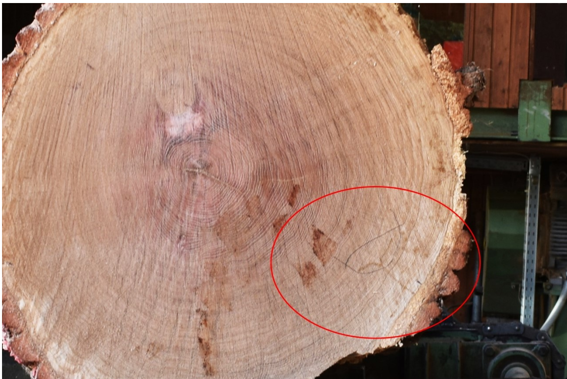
Abb. 10: Der eigentliche Bohrgang liegt vor dem Trennschnitt der Säge, ist aber als „Schatten“ noch darüber hinaus sichtbar. Hier zusätzlich noch mit Bleistift auf dem Holz markiert (Quelle: NW-FVA, Abteilung Waldschutz)
