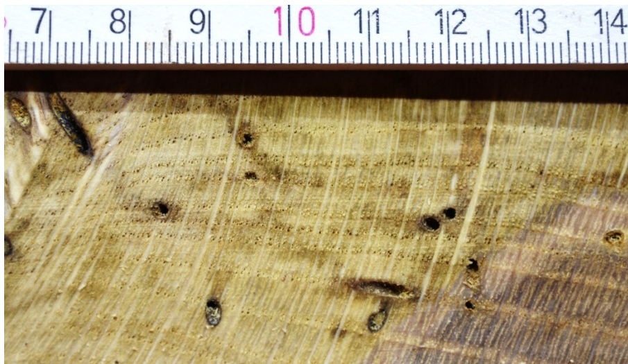
Abb. 4: Alte Gänge (linkes Drittel) mit schwarzem Rand, neuere Gänge (rechtes Drittel) mit noch nicht verfärbtem Myzel. Gänge frei von Bohrmehl, hier sichtbarer Holzstaub in Gängen stammt von der Bearbeitung (Quelle: NW-FVA, Abteilung Waldschutz)
