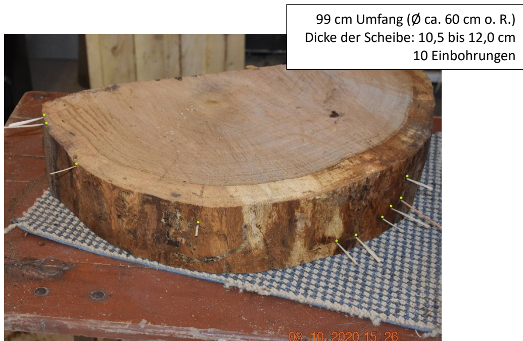
Abb. 5: Markierte Einbohrlöcher an einer Stammscheibe mit 10 Einbohrungen (Quelle: NW-FVA, Abteilung Waldschutz)
